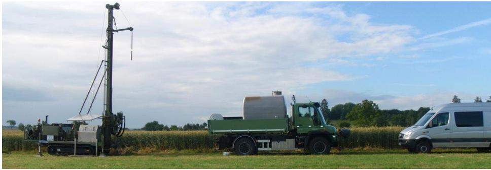
Aufbau des Bohrgeräts inkl. Unimog zur Wasserversorgung und Zubehörtransporter in der Flur.
