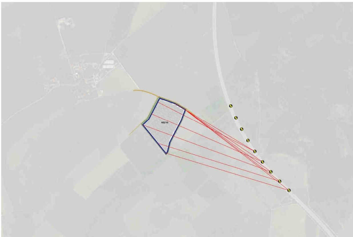
Durch die Ausrichtung der Module auf 193° Südsüdwest bei 15° Aufneigung treten in dieser Situation mit der vorliegenden Querneigung durch das Geländegefälle in Richtung der vermerkten Beobachter nur am äußeren linken Sichtfeldrand Reflexionen bei tief stehender Sonne auf.
