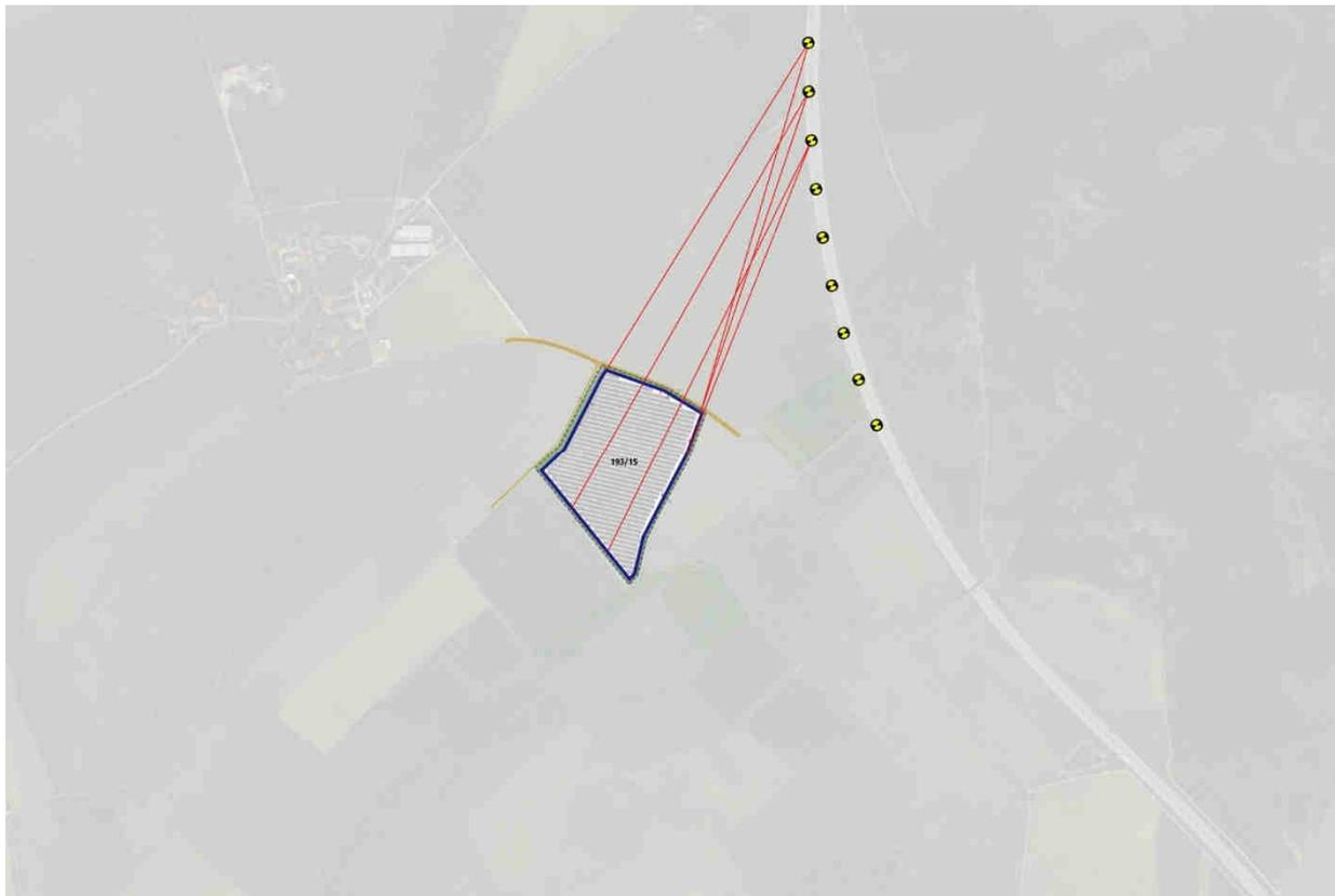
Unter diesen Blickrichtungen können die Modulkonstruktionen nur von hinten gesehen werden, so daß hier keine von den Moduloberflächen ausgehenden Blendwirkungen auftreten können.
